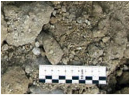
Abb. 8: Fräsbild eines feinkörnigen Bodens
